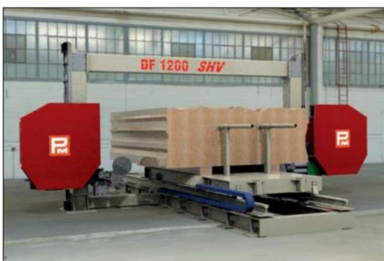
Die Maschine besteht aus einer selbsttragenden Struktur mit zwei Säulen, einem oberen Querträger und dem Schienenstrang für den Blockwagen.
