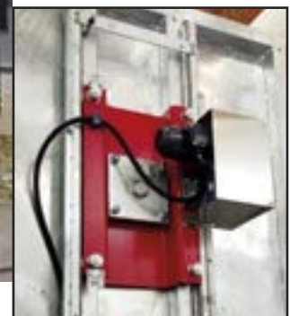
Tensionamento elettronico su entrambi i lati Electronic tensioning system on both sides
