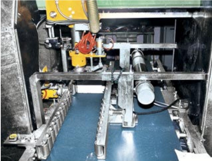
Bocciardatura simultanea di una faccia orizzontale e di una faccia verticale del cordolo - Linea di bocciardatura per cordoli e mattonelle. Simultaneous bush-hammering of a vertical and a horizontal face of the kerb - Bush-hammering line for kerbs and tiles.
